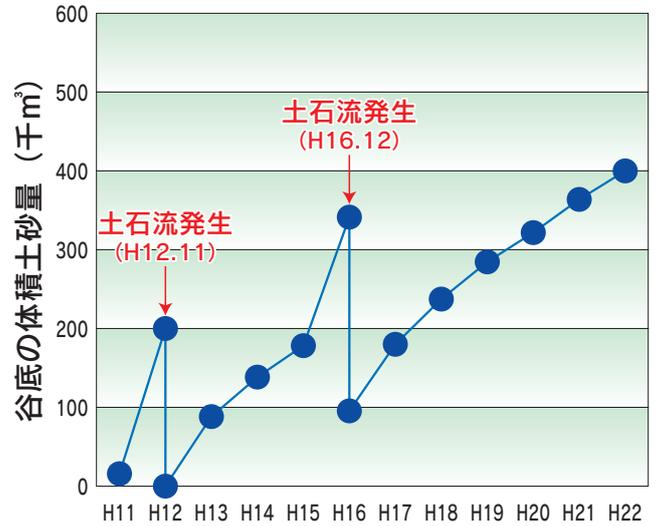
図 大沢崩れ谷底部の堆積土砂量の推移
