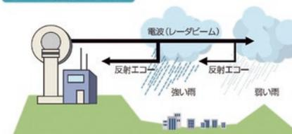
MPレーダ（マルチパラメータデータ）は、水平と垂直の偏波面を持った2種類の電波を放射します。雨から返ってくる信号からいろいろな情報を得ることができます。
