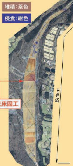
今回の土石流発生後と昨年1月で地面の高さを比較した結果、大沢扇状地には約11万m<sup>3</sup>の土砂が堆積したことがわかりました。これは富士宮市役所約2杯分に相当し、これをすべて運び出すには、延べ22,000台のダンプトラック(10t)が必要です。
