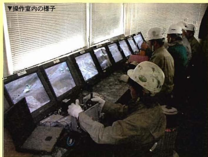
これに対し、無人化施工はGPSや現場監視カメラ、操作カメラなどによる遠隔操縦で現場状況や機械の位置などを把握しながら操作するものです。雲仙普賢岳など噴火後の災害復旧では、ブルドーザやバックホウ、ダンプトラックなどを遠隔操縦し、除石工・構造物撤去工・ブロック積などをを行い、土砂被害の拡大を防ぐ効果を上げています。
