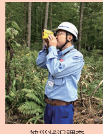
被災状況調査 （レーザー距離計）
