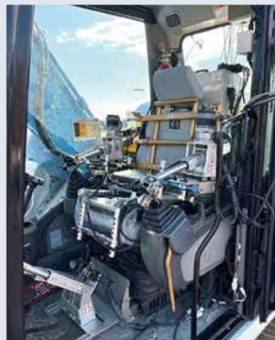
ロボQSの設置状況
