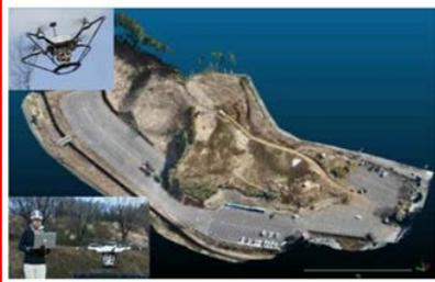
ドローン等による写真測量等により、短時間で面的(高密度)な3次元測量を実施。
