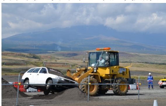
ホイールローダーによる放置車両撤去
