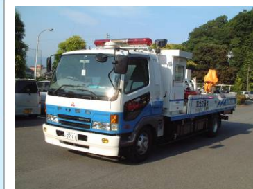
排水ポンプ車
