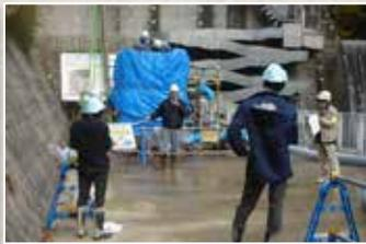
呼び水式サイフォン排水装置を利用した小水力発電実験 (山の谷第1砂防堰堤)
