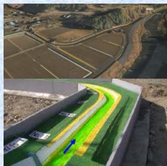
上段は3DCG、 下段は水理模型実験の様子
