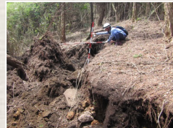
崩落斜面頭頂部 不安定土塊状況 (熊本県南阿蘇村)
