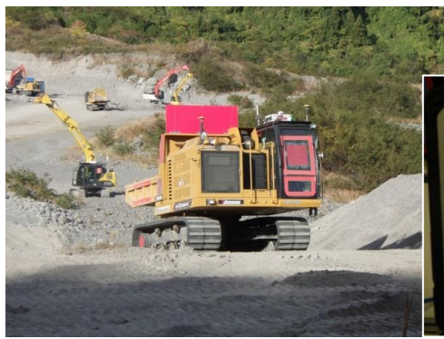
クローラダンプによる自動施工状況
