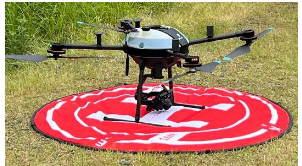
小型の発電機を搭載し、内蔵バッテリーを充電しながら飛行するハイブリッドドローン
