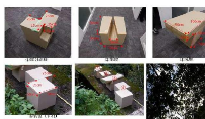
上空が樹木で覆われた砂防堰堤袖部に置いたダミー変状(段ボール箱) 数cmの精度で識別できた
