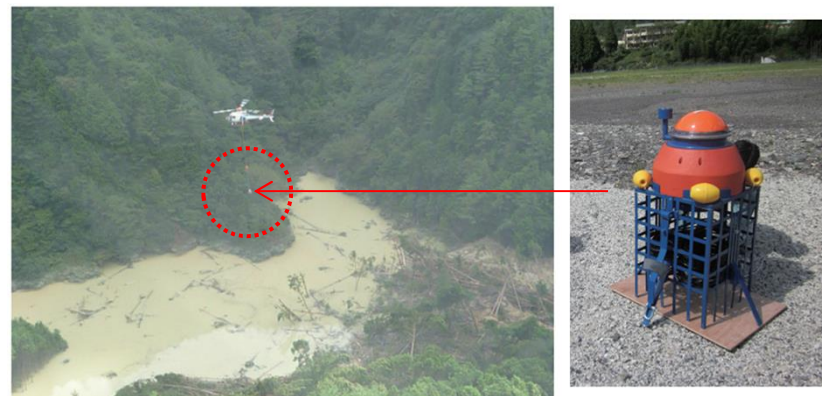
水位計の設置（投下型水位観測ブイ）
