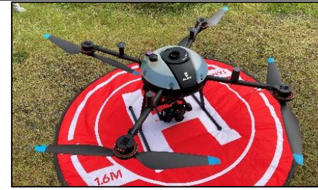
小型の発電機を搭載し、内蔵バッテリーを充電しながら飛行するハイブリッドドローン
