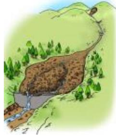
大雨と一緒に大量の土砂が流れてくると、川の勾配がゆるい堰堤の上流側で水のスピードが遅くなり、既にたっていた土砂の上にさらに大きく一部が積もってまいります。
