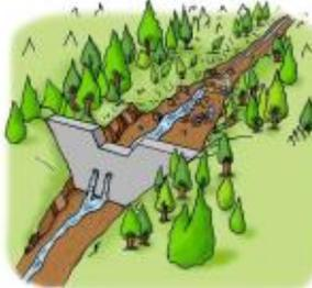
不透過型砂防堰堤を設けると、堰堤の上流側に土砂が少しずつたまっていきます。土砂をためる量を確保するため、取り除くこともあります。
