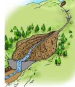
上にたまった土砂はその後、雨が降るたびに水の力で削られ、少しずつ下流に流れ出ていきます。(その後、大雨が降ると再び大きく積もってまいります。)
