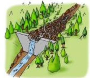
土石流が発生したとき、堰堤は大きな土砂や流木をためて、下流への被害を防ぎます。
