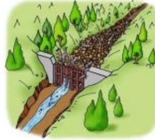
大雨が降り土石流が発生したとき、大きな岩、流木などを含む土砂は、堰堤に引っかかり止まります。
