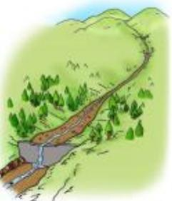
不透過型砂防堰堤は、土砂で一杯になっても、効果がなくなるわけではありません。堰堤の上流側では、土砂がたまって川の勾配がゆるくなり、川幅も広がるため、水が流れるスピードも遅くなります。
