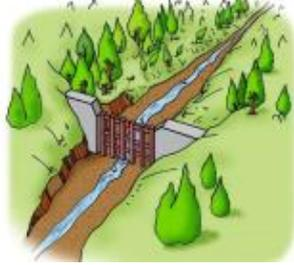
透過型砂防堰堤を設けた場合でも、普段は、水と土砂は同じように下流に流れていきます。
