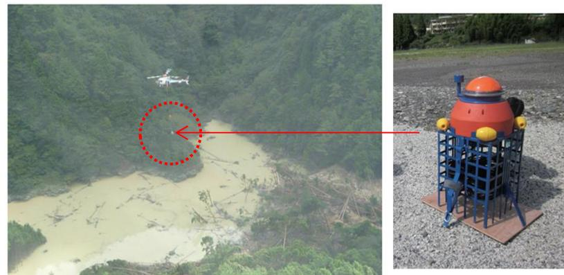
水位計の設置（投下型水位観測ブイ）
