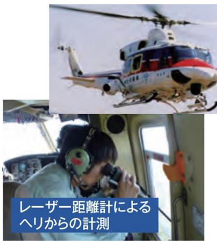
レーザー距離計によるヘリからの計測
