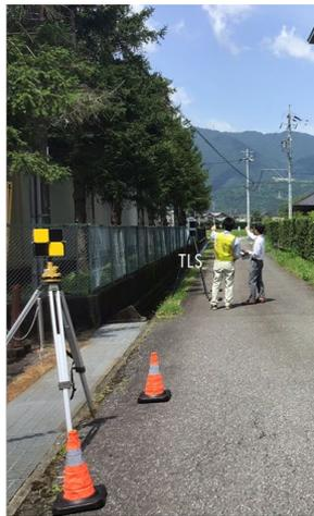
DX (TLS等による胸高直径計測状況)
