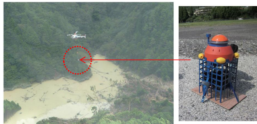
水位計の設置（投下型水位観測ブイ）
