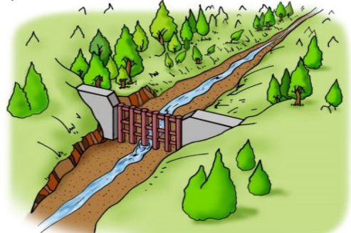
② 透過型砂防堰堤を設けた場合でも、普段は、水と土砂は同じように下流に流れていきます。
