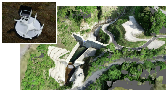
UAV撮影写真から砂防堰堤の3次元モデルを作成
