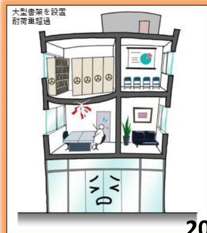
12. 床の耐荷重が超過している状態
