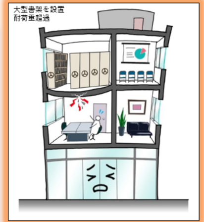
12. 床の耐荷重が超過している状態
