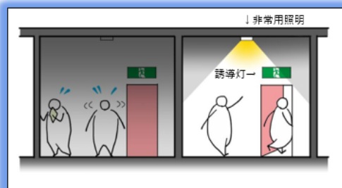
01. 非常用照明が点灯しない状態 誘導灯が点灯しない状態
