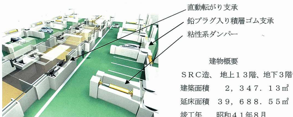
地下2階免震装置設置状況
