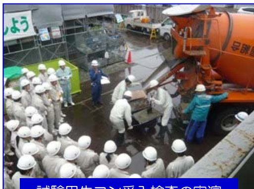
試験用生コン受入検査の実演
