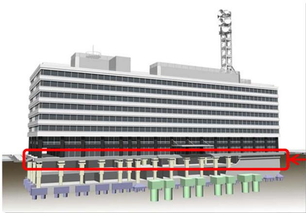
地下1階の上部に免震装置を設置
