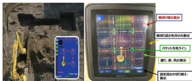
掘削形状(位置・深さ)に関するデータをICT建機にインプットし制御。
