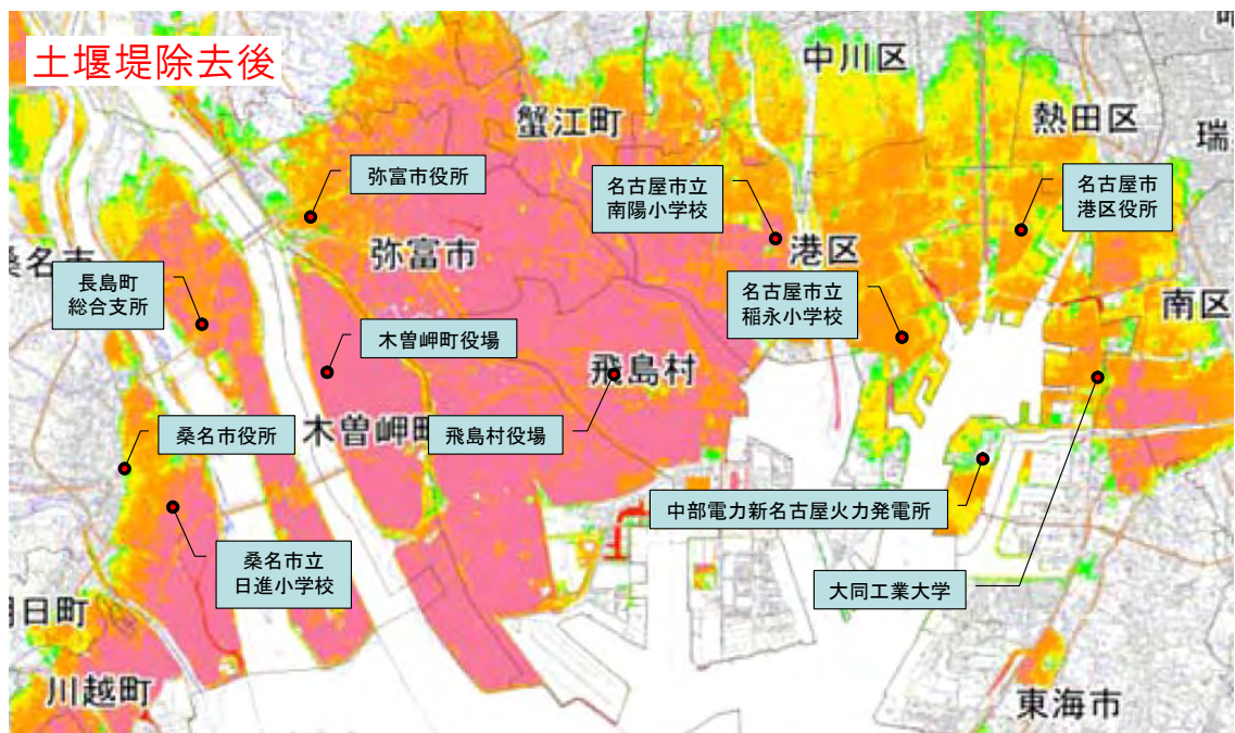
【ケース①「駿河湾～紀伊半島沖」に「大すべり域、超大すべり域」を設定、堤防条件：地震発生から3分後に破堤】
