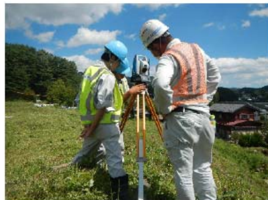
UAVでの撮影後、標定点を測量
