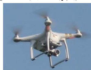
UAV(ドローン等)による3次元測量
