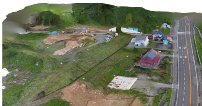
現地での測量開始から、点群データ完成までの所要時間：約6時間
