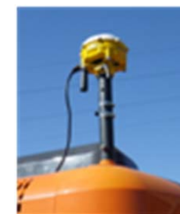
移動局(GNSS受信機) GPS+GLONASSの受信機。 油圧ショベルの3次元位置や 向きをリアルタイムに測定。
