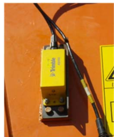
チルトセンサ(アーム) 角度を測定。
