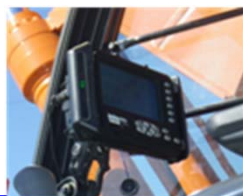
コントロールボックス 3D施工データの読込。 油圧ショベルの切盛、 バケットの傾きを表示。
