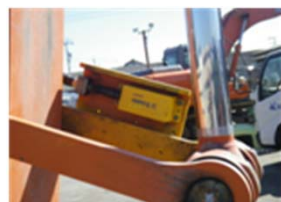
チルトセンサ(バケット) 角度を測定。
