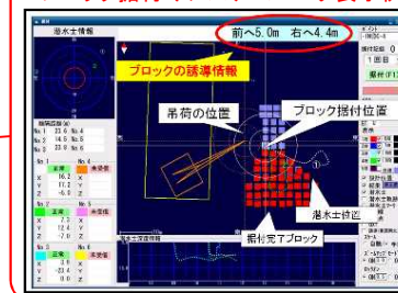
ブロック据付けシステムモニタ表示例
