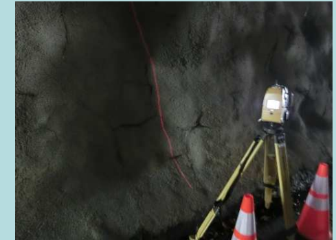
TLSによる測定状況
