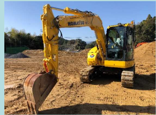
0.28m 3 級BH(幅狭バケット装着)
