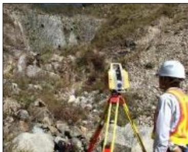
人の立入が危険な急傾斜地でも、短時間で面的に3次元測量を実施
