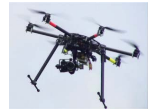
UAV等による 三次元測量
