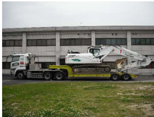
トレーラーに積載された無人化施工バックホウ
