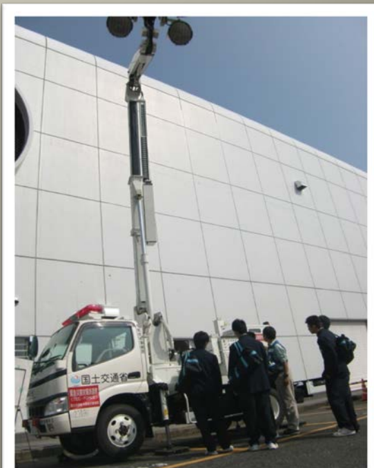
排水ポンプ車 大雨や洪水で河川から溢れ出した水を、搭載したポンプで排出します(DSシステム搭載)
