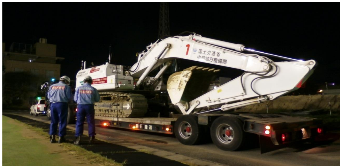
10月6日22時 中部技術事務所を出発する無人化施工バックホウ
