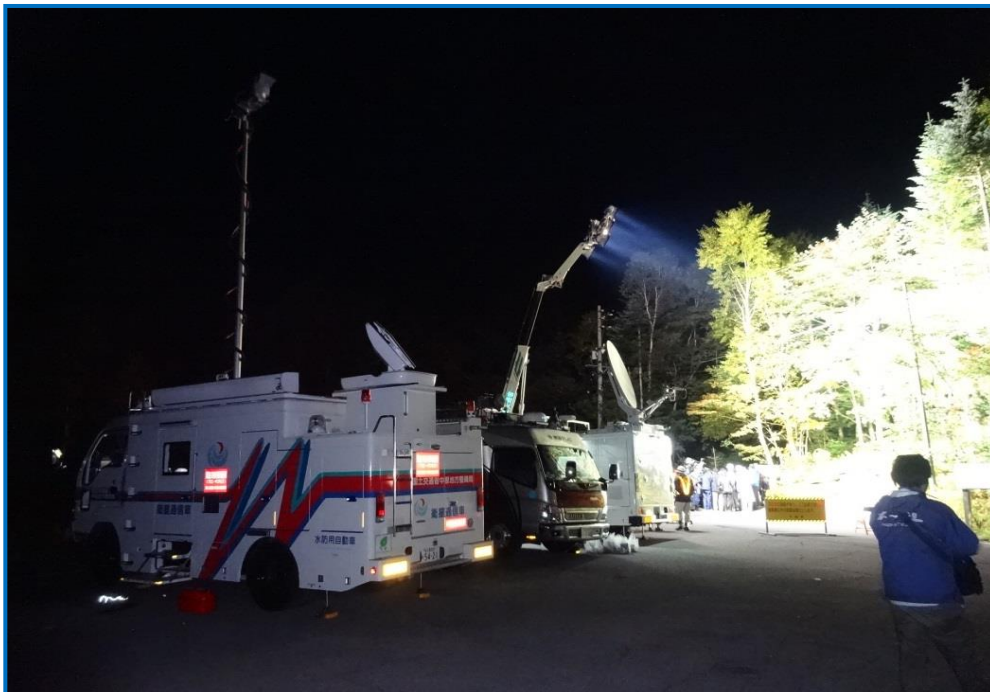
濁河(にぎりご)温泉登山口にて登山者の救助活動を支援する照明車(高山国道)と状況を映像配信する衛星通信車
