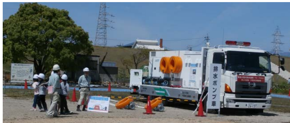
排水ポンプ車 洪水時に排水を行います
