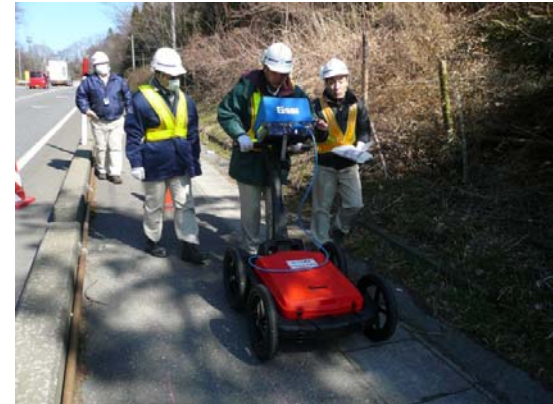
復旧後の陥没箇所周辺を、当事務所がハンディ型地下レーダー探査機を用いて空洞調査している状況
