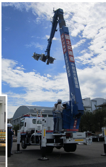
【照明車 操作体験↑→】 (上：照明車20m級) (右：照明車10m級)
