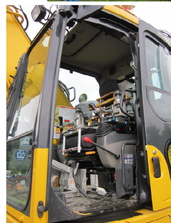
（写真上）ロボQS取付けバックホウ （写真左）ロボQS取付け状況 （写真下）遠隔操縦状況
