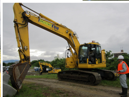
（写真上）ロボQS取付けバックホウ （写真左）ロボQS取付け状況 （写真下）遠隔操縦状況
