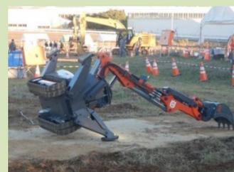
電動遠隔解体ロボット実演(3点支持が可能)
