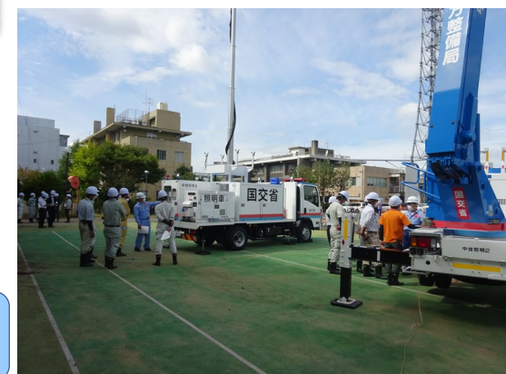
照明車10m級(奥) 20m級(手前)
