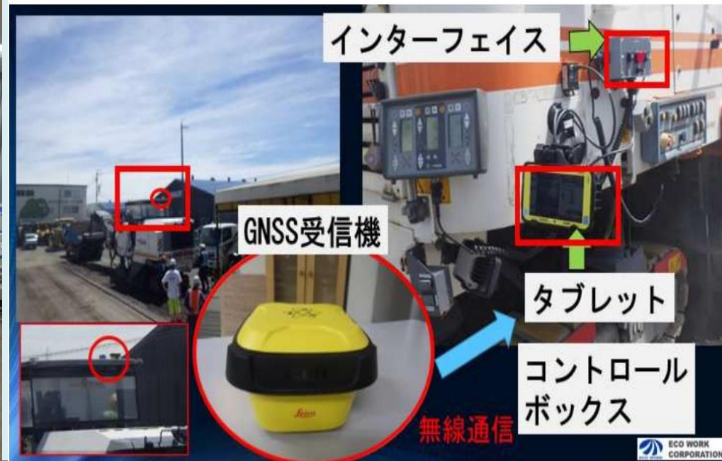
GNSSを用いたMC切削機 構造図
