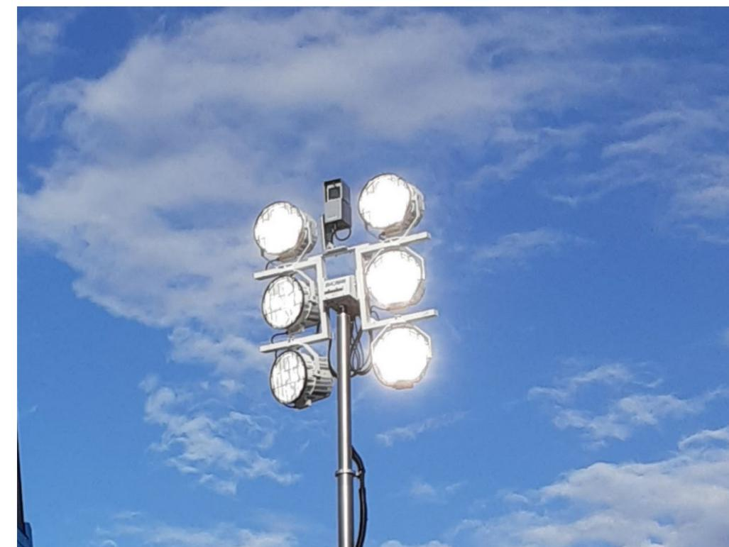
LED式照明装置 (1.3kW×6灯)
