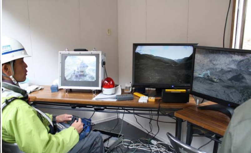
遠隔操縦作業（操縦室）
