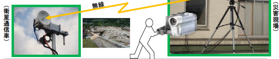
無線中継装置「パソリンク」により、衛星通信車より2km程度離れた場所の映像も伝送可能
