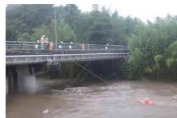
ADCP(超音波流速計)による流量観測
