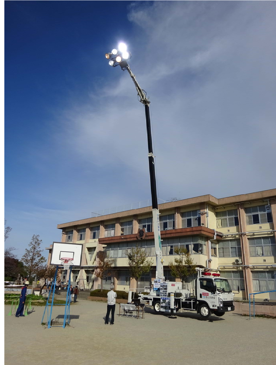
20mの高さから災害現場を明るく照らすことが可能です
